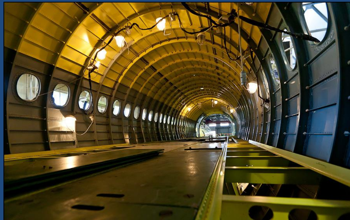
Фюзеляж-полумонокок самолета Sukhoi Superjet 100. Нормальные шпангоуты и стрингеры.
